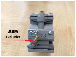
● 调整: 顺时针转动怠速螺丝将增大怠速转速,同时要配合低速油针一起调整,顺时针转动油针为减少油量,(调整时把油针拧到底再退回,出厂位置,L低速油针 1.0 圈,H 高速油针 1.0 圈)最好使用转速表来调整,使发动机达到最高转速,加减速顺畅为最佳。
